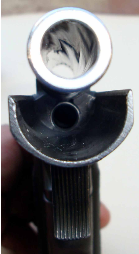
El cañón poligonal y debajo la cámara de gases que retarda la apertura.
