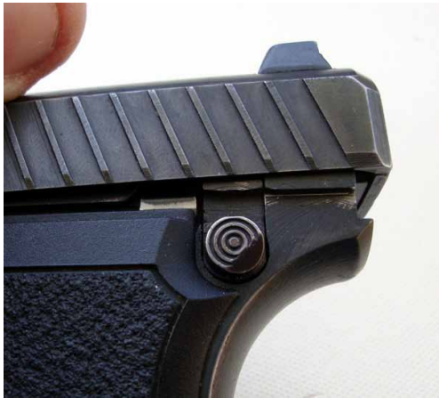
Presionando el botón se puede levantar la corredera de sus guías para desarmar la pistola.
