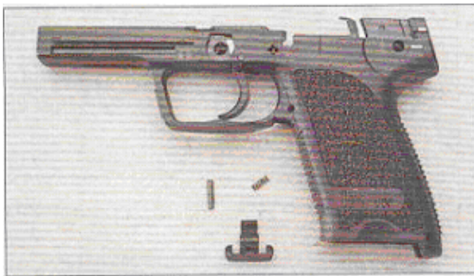
22.- Un pasador-eje transversal sujeta al retén de cargador ambidextro con su muelle.
